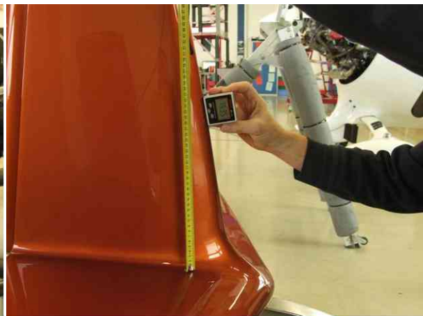
Abb. 5 - Einstellwinkel des Leitwerks messen
