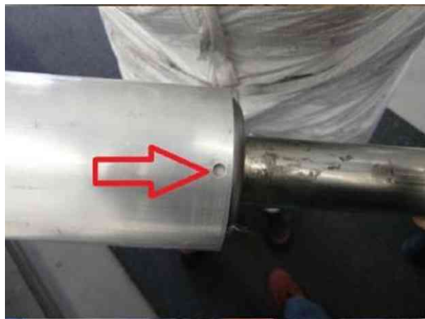
Abb.5 - Nieten an der Abgasausgangsseite
