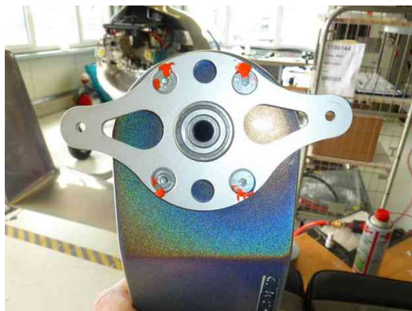
Abb. 3 - Ruderhorn ( das Ruderhorn ist so ausgelegt, dass bei gleicher Länge der Steuerseile das Seitenruder um 7.5^\circ nach rechts ausgeschlagen ist)
