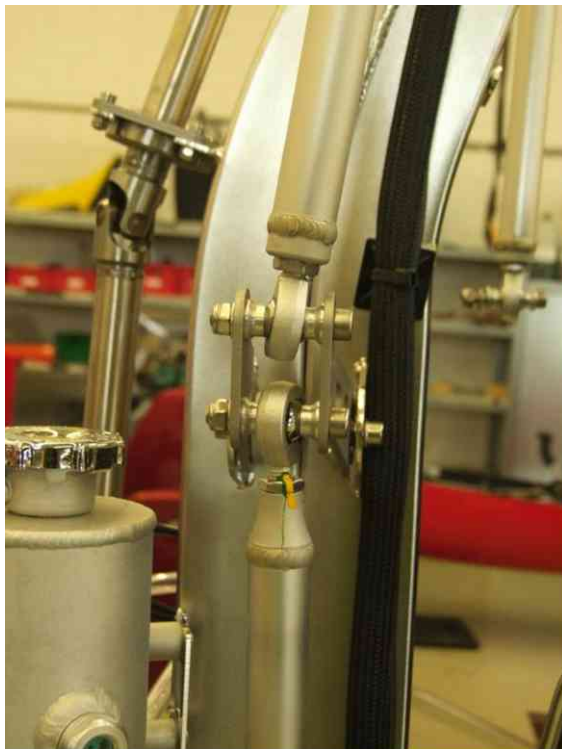
Abb. 2 - Verbindung des oberen Kugelkopfes der unteren rechten Steuerstange mit Umlenkhebel (Schritt 3/5)
