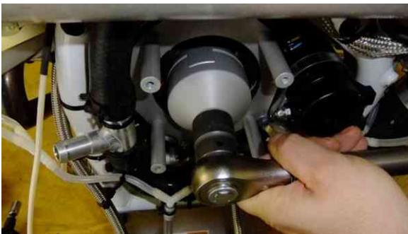
Abb. 5 - Mitnehmer mit 140 Nm festziehen
