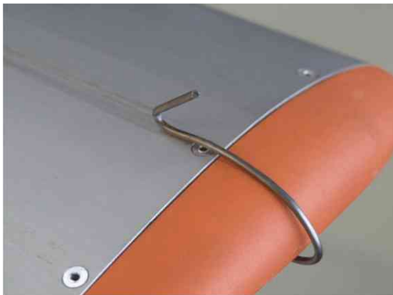
Abb. 2 - Positionierung der Messschnur
