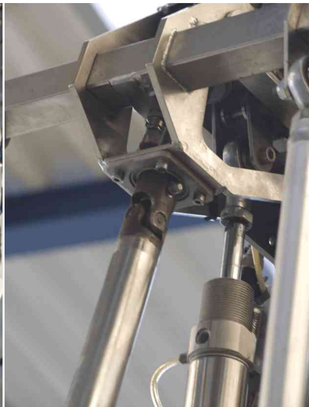
Abb. 4 - Kugelkopf und Kardangelnk wieder anbauen (Schritt 10/11)
