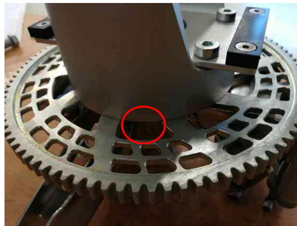
Abb. 2 - Loch bzw. Magnetscheibe auf 7 Uhr Position in Flugrichtung
