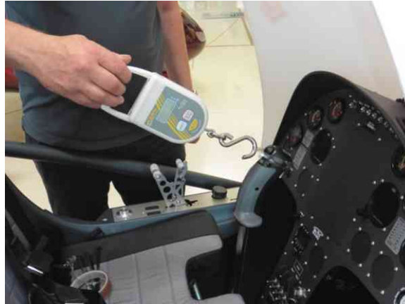
Abb. 1 - Messung der Reibkraft Rotorsteuerung
