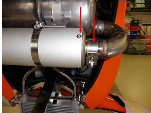
Abb.1 - Nieten an der Abgaseingangsseite und Gelenkbolzenschelle
