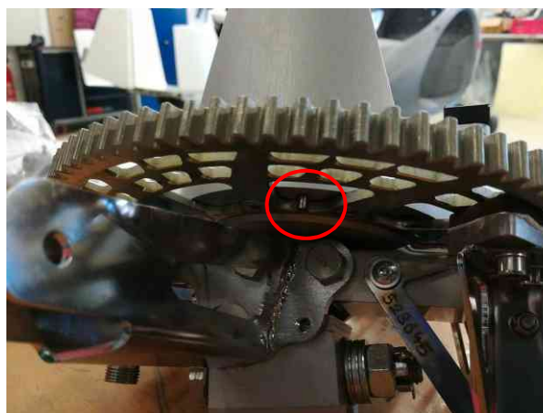
Abb. 3 - Loch bzw. Magnetscheibe auf 7 Uhr Position in Flugrichtung
