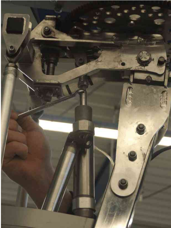
Abb. 1 - Kolbenstange von Kugelkopf lösen (Schritt 4)
