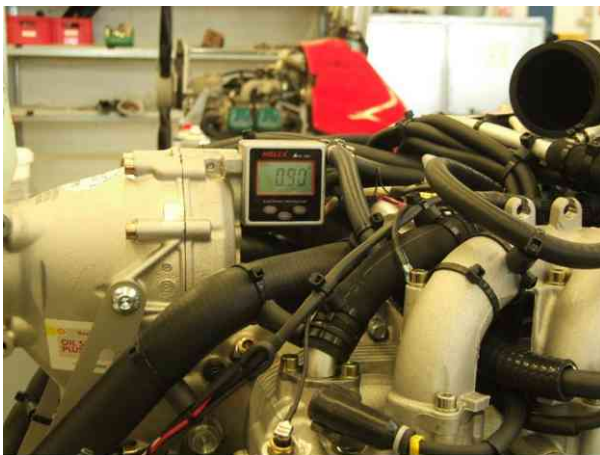
Abb. 4 - Winkel der Schubachse messen
