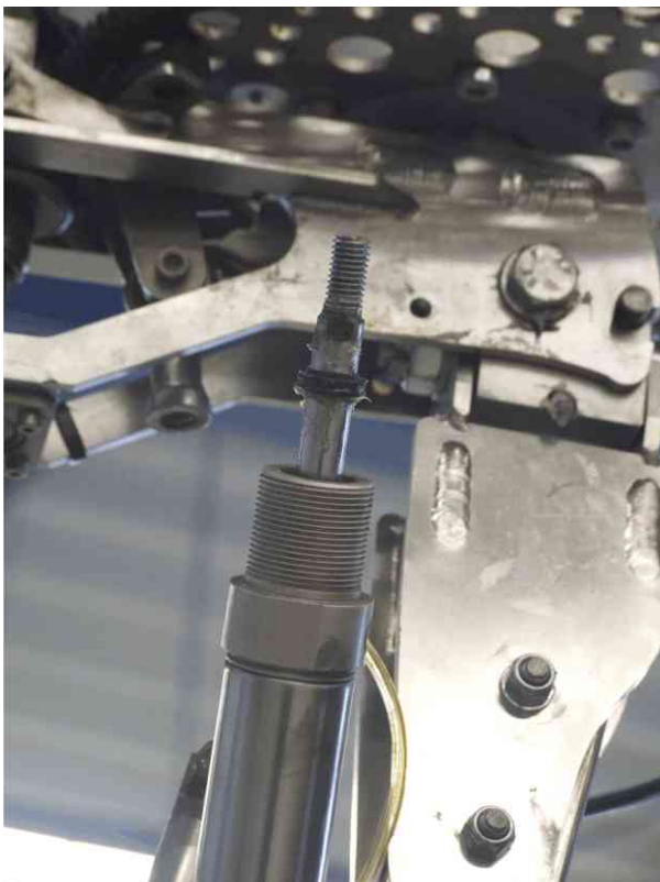
Abb. 3 - Neuer Dichtungsring mit Spezialfett (Schritt 8)
