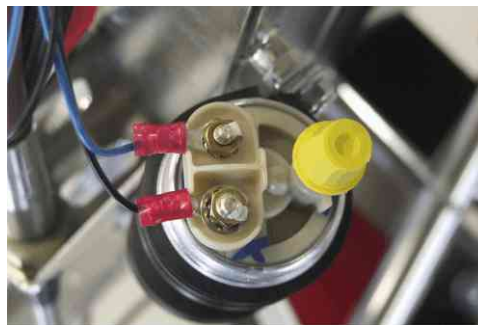
Abb. 5 - Klemmstellen der el. Kraftstoffpumpe
