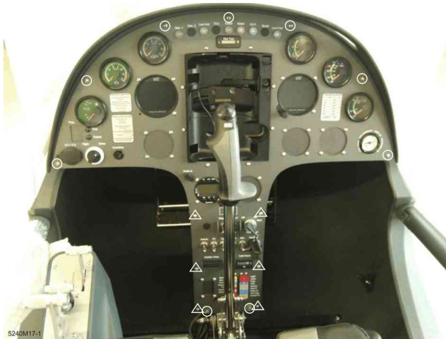
Abb. 1 - Instrumentenpanel mit Befestigungsschrauben
