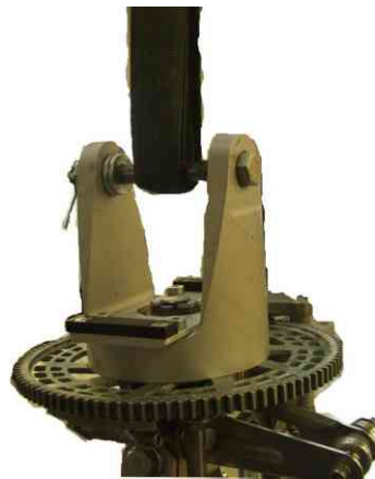
Abb. 1 - Hebegurt um Teeterbolzen
