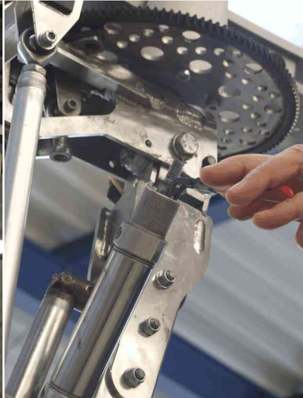
Abb. 2 - Sprengring ausbauen (Schritt 6)
