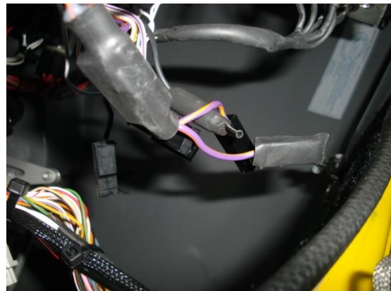
Abb. 4 - Isolierung des Kabelendes
