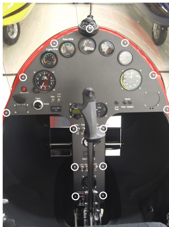
Abb. 3 - Instrumentenpanel mit Befestigungsschrauben
