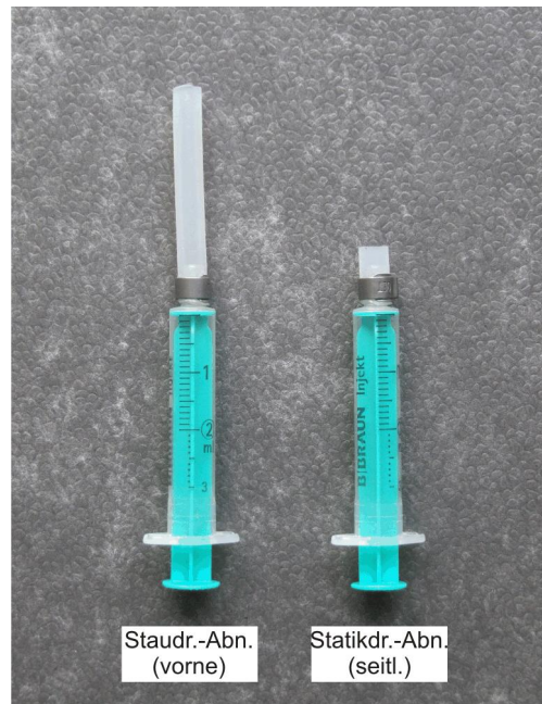
Abb. 1 - Testausrüstung zur Stau-Statik Dichtheitsprüfung
