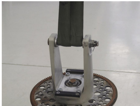
Abb. 1 - Hebegurt um Teeterbolzen
