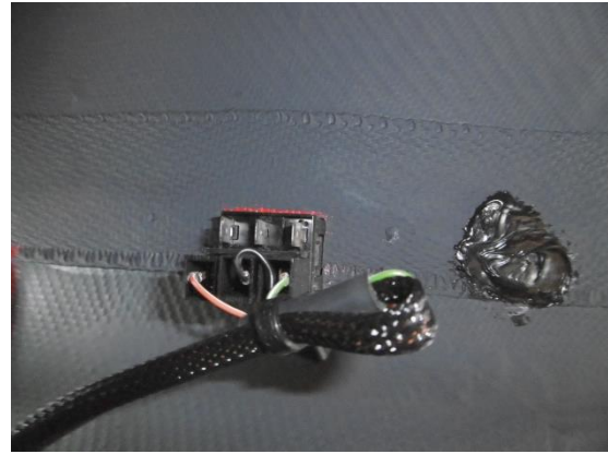
Abb. 8 - Angeschlossener Wippschalter von unten
