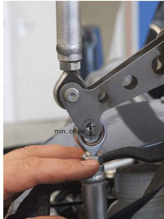
Abb. 3 - Messung des Versatzes
