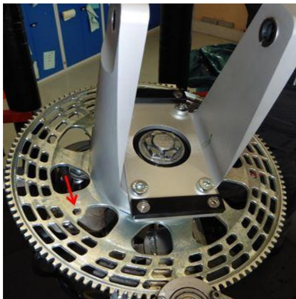
Abb.4 - Loch bzw. Magnetscheibe auf 7 Uhr Position in Flugrichtung
