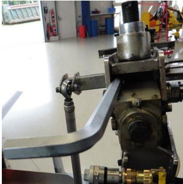
Abb.3 - Inbusschlüssel zwischen Rotorkopfbrücke und Bolzenkopf
