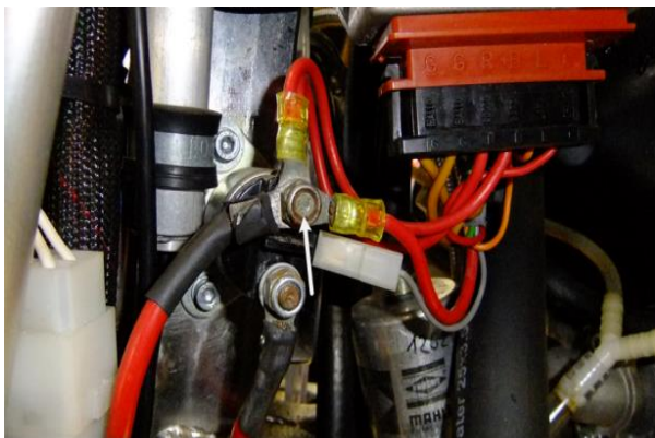
Abb. 1 – Pluspol am Starterrelais
