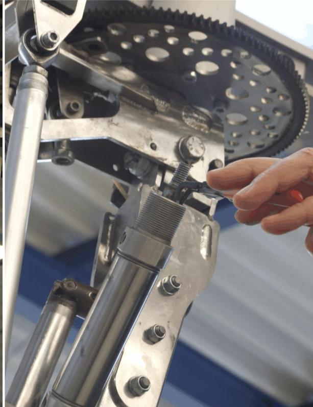
Abb. 2 - Sprengring ausbauen (Schritt 6)
