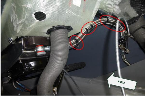
Abb. 15 – Vorderer Anschluss und Fixierung der Stahlflex-Leitungen
