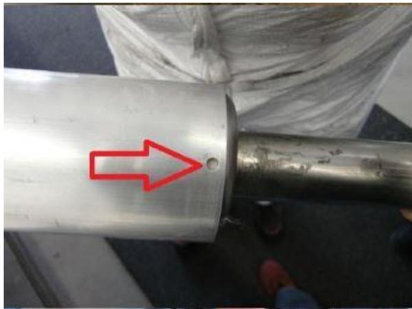
Abb.5 - Nieten an der Abgasausgangsseite
