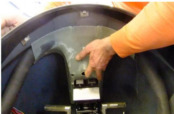
Abb. 3 – Übertragen der Heizungskontur
