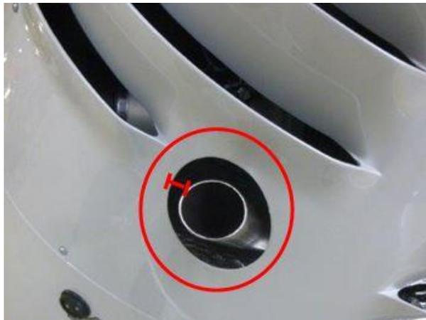
Abb.8 - Ausrichten des Endrohres
