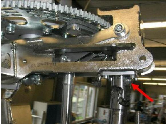
Abb. 1 - Oberer Prerotator-Antriebstrang an Bendix-Welle
