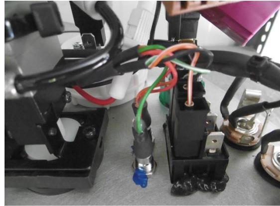
Abb. 8 - Wippschalter und LEDs - von hinten gesehen
