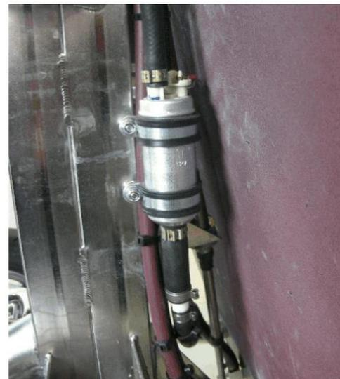
Abb. 4 - El. Kraftstoffpumpe (re.)
