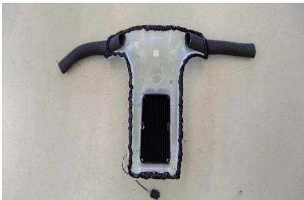
Abb. 5 – Heizluftführung vor dem Einkleben
