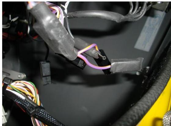
Abb. 4 - Isolierung des Kabelendes
