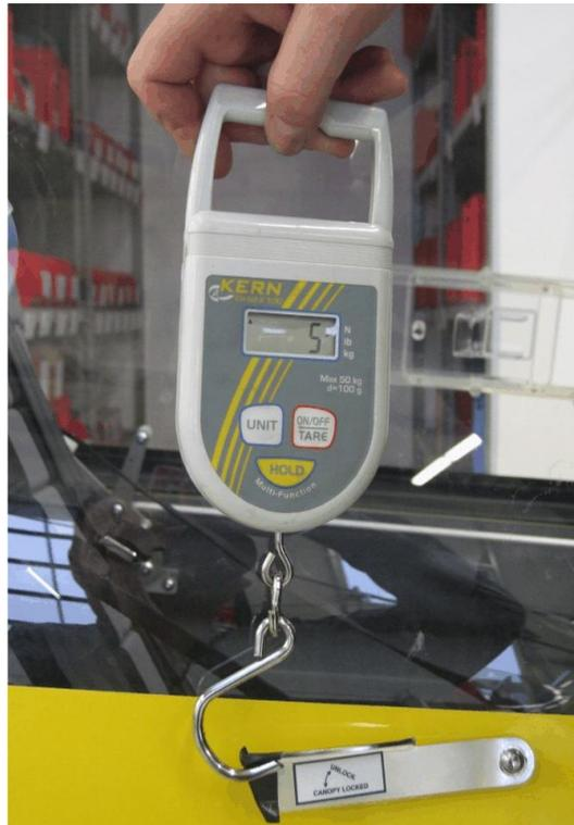
Abb. 1 - Messung Losbrechkraft Verriegelung
