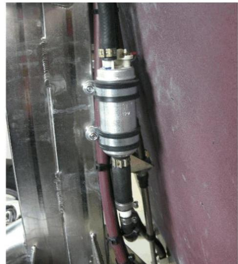
Abb. 4 - EI. Kraftstoffpumpe (re.)
