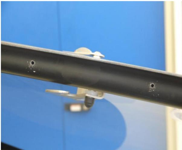
Abb. 3 - Fertige Bohrungen für die Abstandhalter
