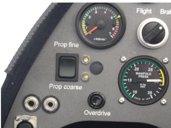
Abb. 5 - Wippschalter und Einbauposition der LEDs
