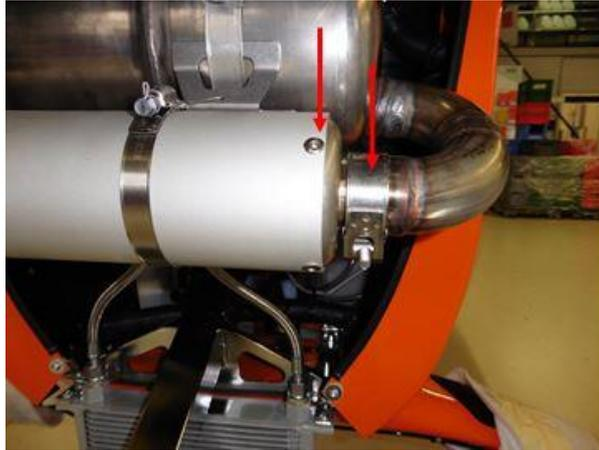
Abb.1 - Nieten an der Abgaseingangsseite und Gelenkbolzenschelle
