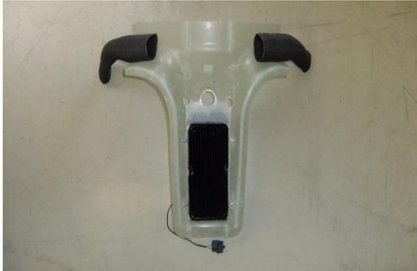
Abb. 1 – Heizluftführung mit Heizluftschläuchen
