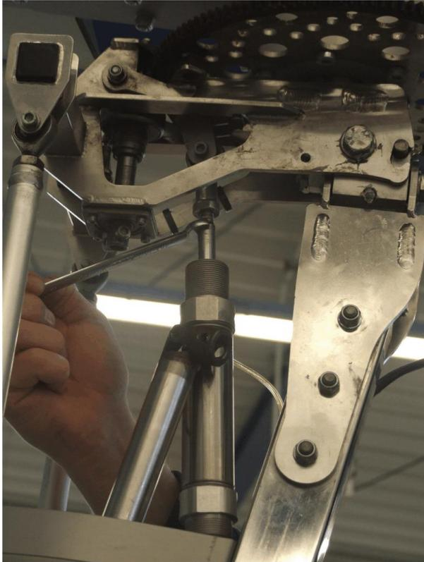
Abb. 1 - Kolbenstange von Kugelkopf lösen (Schritt 4)
