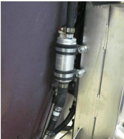
Abb. 3 - EI. Kraftstoffpumpe (li.)
