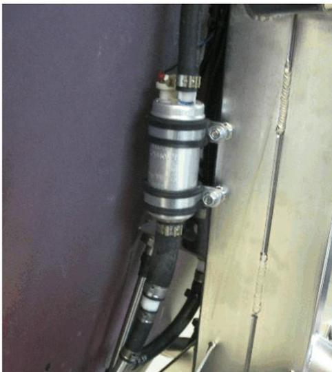
Abb. 3 - El. Kraftstoffpumpe (li.)
