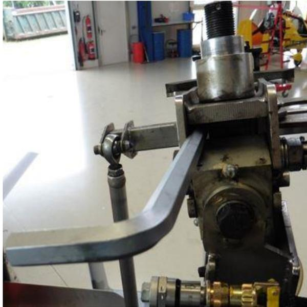
Abb.3 - Inbusschlüssel zwischen Rotorkopfbrücke und Bolzenkopf
