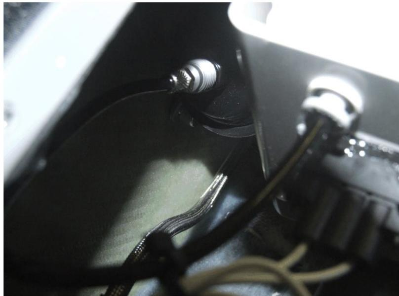
Abb. 1 - Wartungsdeckel (geöffnet) unter hinterem Sitz - Trocknerpatrone
