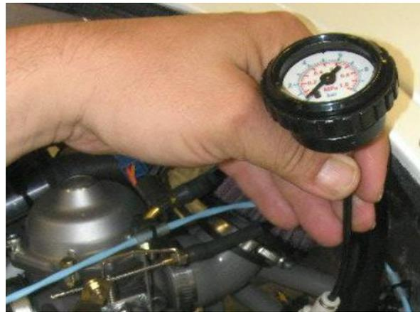
Abb. 4 - Anschluss zwischen Kupplung und Druckbegrenzer
