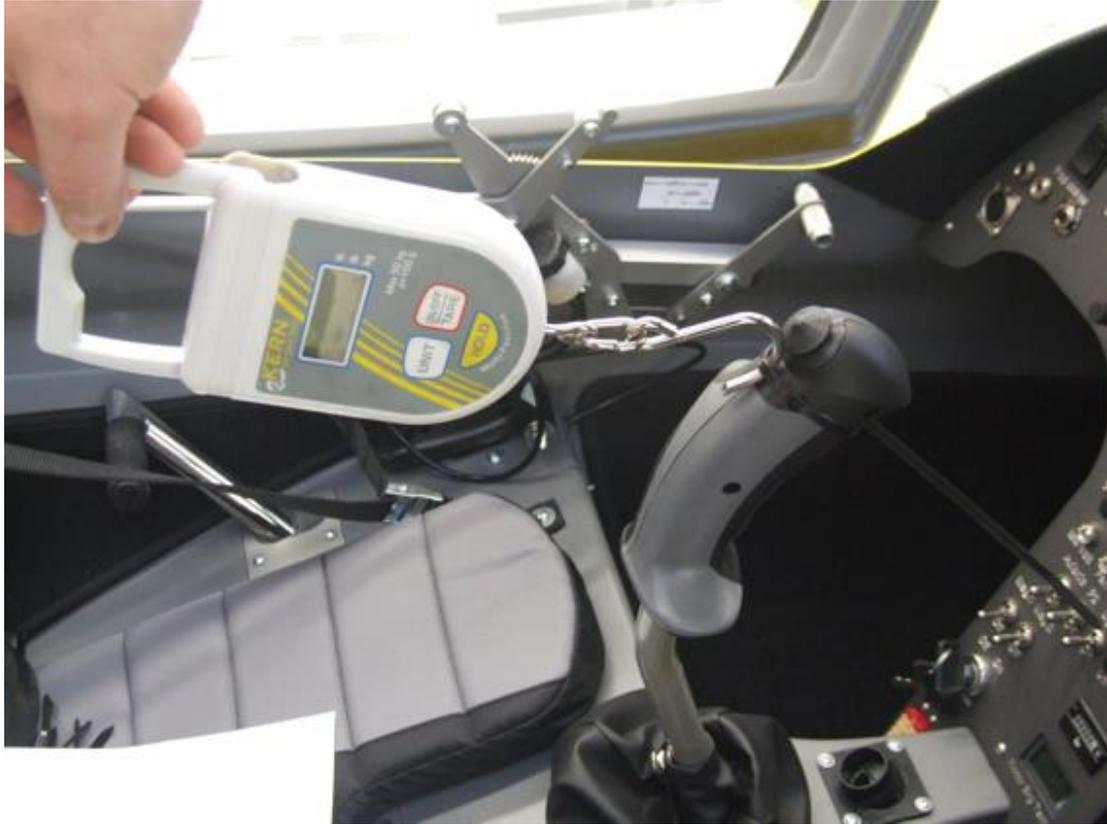
Abb. 1 - Messung der Reibkraft Rotorsteuerung
