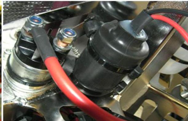
Abb. 4 – Kondensator
