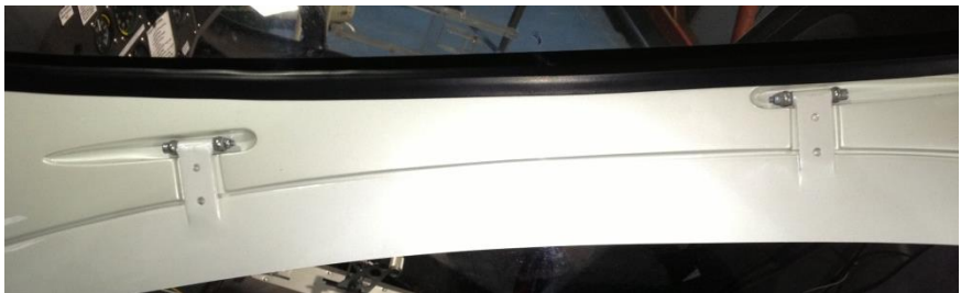
Ansicht der Türscharniere (hier linke Türe), die die Ausrichtung der Bolzen zeigt
