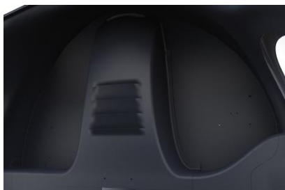
Luftführung mit Luftauslässen (dahinter Verdampfer)
