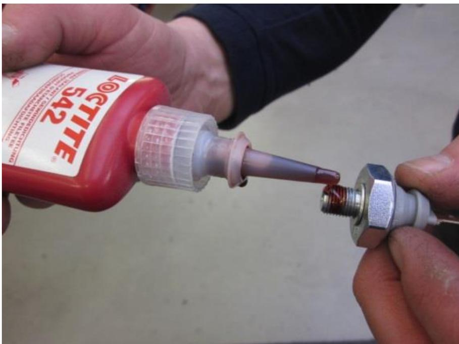
Abb. 2 Benetzung mit Loctite 542
