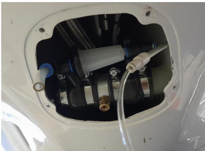
Abbildung 34: Entlüftungs-Leitung vom Filter getrennt und Druck-Test-Gerät an die Entlüftungsleitung angeschlossen
