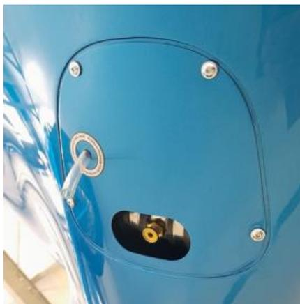
Abbildung 4: Wartungsdeckel unten
