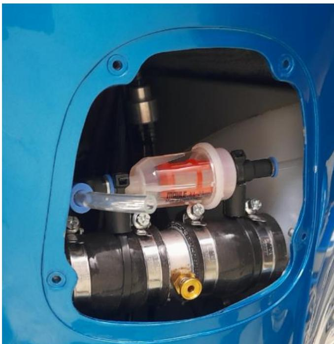
Abbildung 31: Eingebaute Entlüftungsleitung mit Filter
