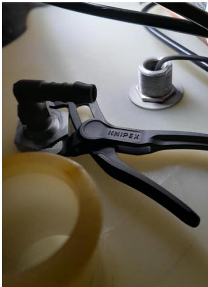
Abbildung 23: Anwendung einer Parallelzange um die äußere Mutter festzuziehen
