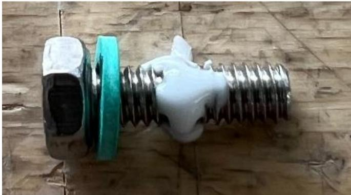
Abbildung 32: Anwendung von Loctite 5331 an den Schrauben des Tankdeckels
