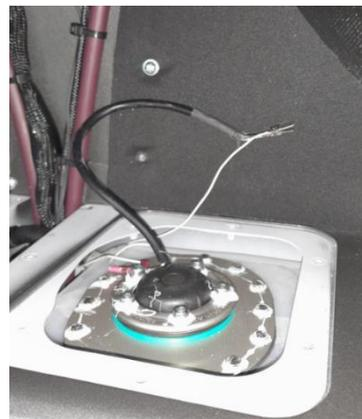
Abbildungen 6 – 12: Stecker-Trennung, Sicherheitsverschluss entfernen, Kontakte entfernen
