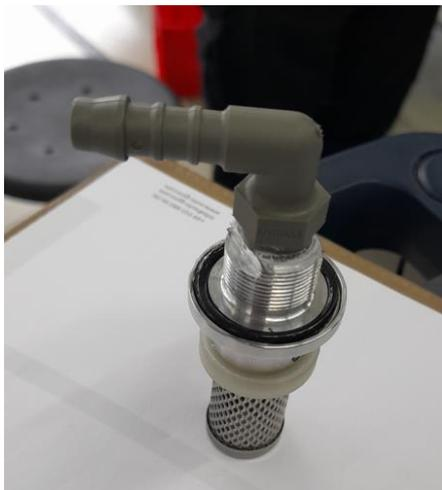
Abbildung 22: Neuer Tank-Entnahmewinkel mit eingefettetem Dichtring
