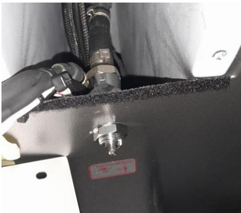
Abbildung 27: Neuer Brandhahn montiert
