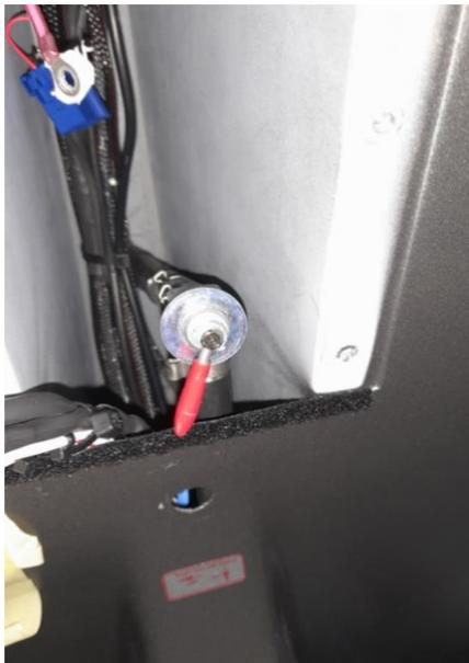
Abbildung 24: Vorhandener Brandhahn gelöst und nach hinten verschoben
