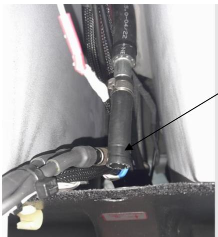
Einohr-Schelle entfernt, Kraftstoff-Schlauch vom Brandhahn gelöst. Der Schlauch muss um etwa 10mm gekürzt werden, die Erklärung erfolgt in der Beschreibung des nächsten Arbeitsschritts.
