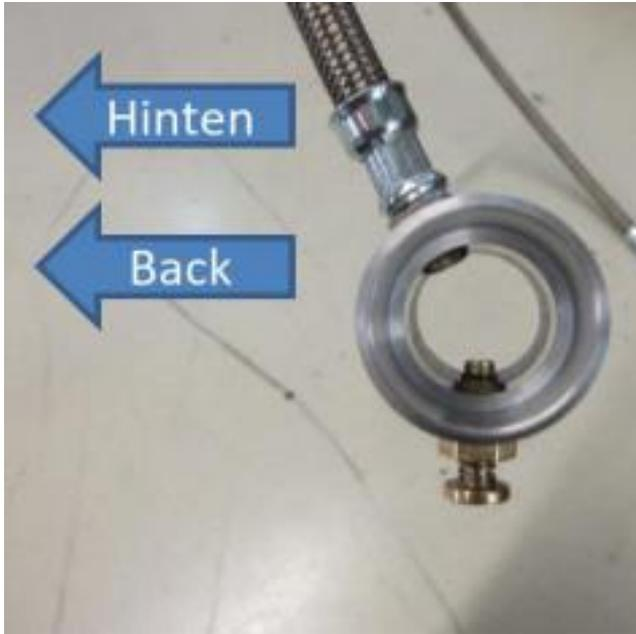
Abbildung 29: Einbaurichtung des Ablass-Ventils
