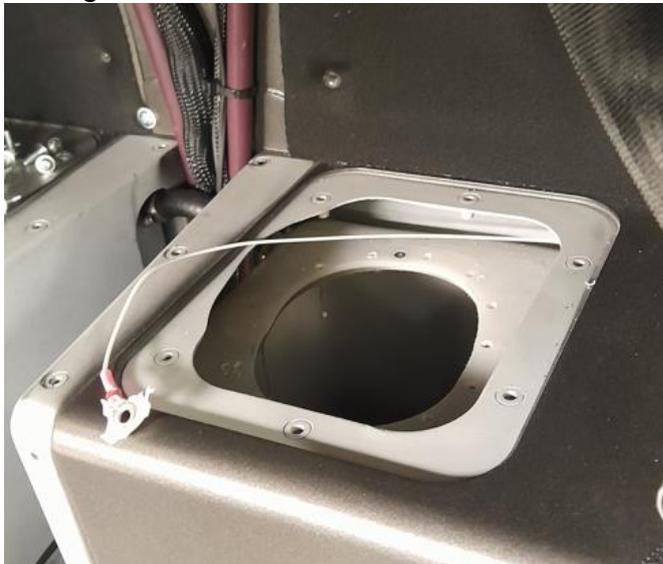
Abbildung 13: Füllstands-Sensor entfernt
