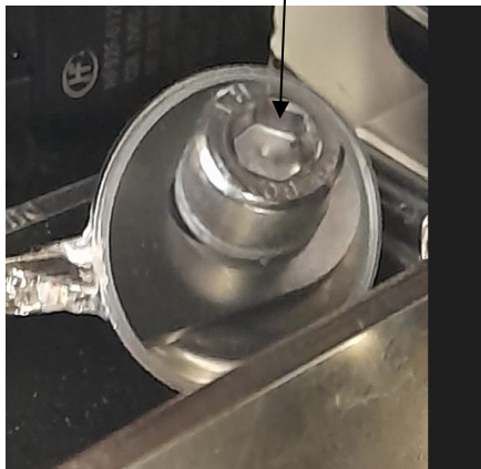
Schraube mit Nord-Lock Keilsicherungscheibe
