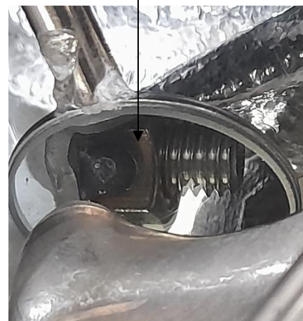
Angeschweisste Mutter an der Aufhängung des Turboladers
