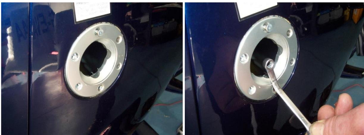
**Bild 2+3: Tanköffnung und Ringspanner**
