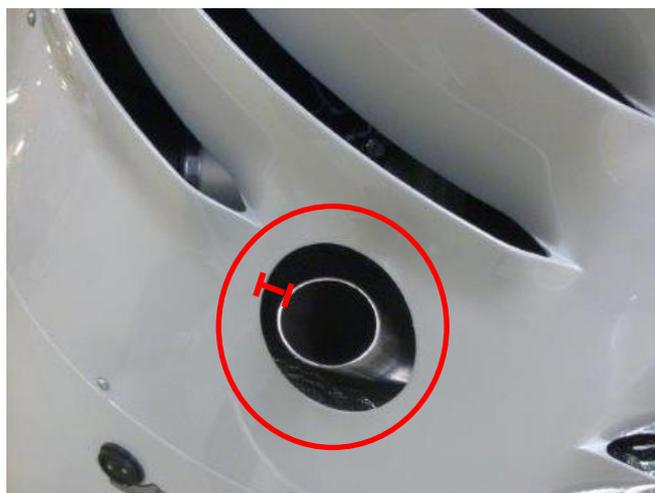
Abb.7: Ausrichten des Endrohres
