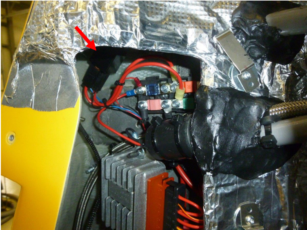
Abb. 3 – Position des Kraftstoffpumpenrelais (Cavalon)
