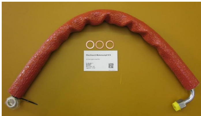
Abb. 2 - ,Ölschlauch Motorsumpf' aus Gummi (zu ersetzen/alt)
