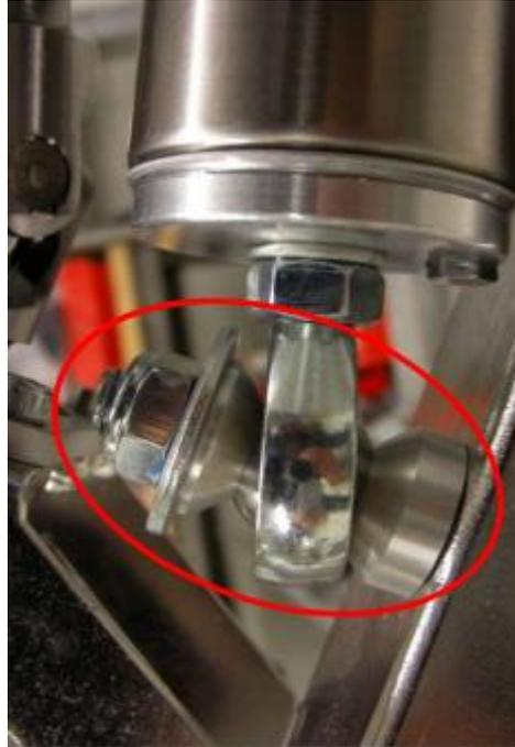
Rotorkopf III 21,5 (46039): Montage der oberen Befestigung des Brems-Trim-Zylinders am Rotor mit der Schraube M6 56/10 A4-80 + 2x Abstandshalter und 2x Unterlegscheibe U6 A.
