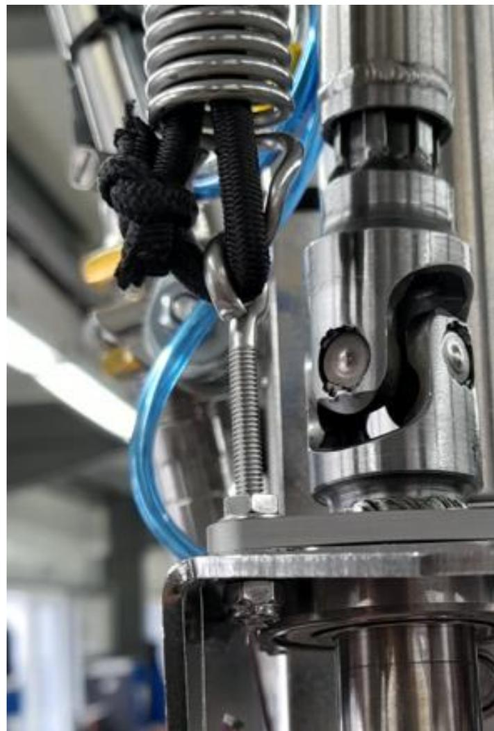
10. Mast wieder am Flugzeug montieren gemäß Job Card 62-51-00 8-1, Schritte 12 – 24. Bitte beachten dass es eine Änderung gibt die noch nicht im Wartungshandbuch eingearbeitet ist. In der oberen Aufnahme des Mastes wird eine Gummi-Buchse 90 Shore mit der Artikelnummer 11082 verwendet. Zusätzlich die Verlängerung der PPC in den Bildern überprüfen.
