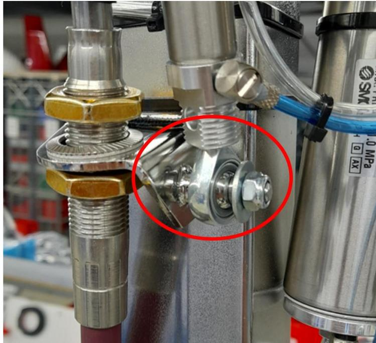
Montage des Roll-Trim-Zylinders am vorher montierten Bolzen mit Abstandshaltern ( Winkel in Richtung Kugelkopf) wie gezeigt. Sicherung mit Scheiben U6/18 und Kontermutter M6 Si. Rotorkopf durch den gesamten Schwenkbereich bewegen und sicherstellen dass es keine Blockade des Roll-Trim-Zylinders gibt. Wenn notwendig weitere Scheibe U6 zwischen PPC Befestigung und dem inneren Abstandshalter einfügen wie abgebildet.
