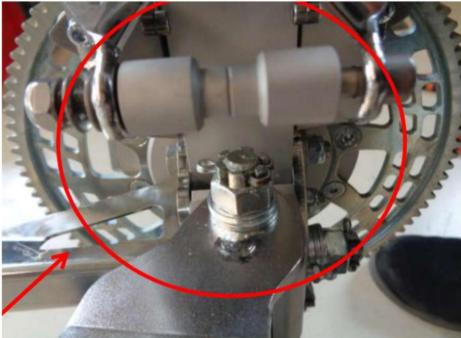
**Achtung:** Die Kronenmutter muss sich in einer Position befinden in der es möglich ist, den Splint leicht mit der Hand einzufügen!
