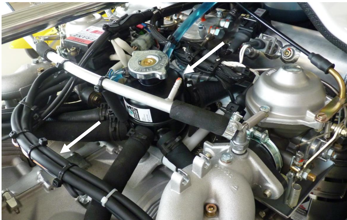
Abb. 3 – Motorseitiger Anschluss für Ladedruckanzeige und vorbereiteter Schlauch im Kabelbaum (MTO)
